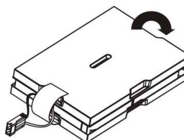
Рисунок 9. Порядок сборки комплекта из трех батарей.
