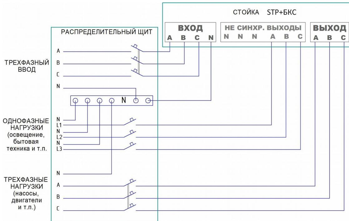
Рисунок 1. Рекомендуемая схема подключения Стойки STP+BKS к сети.
