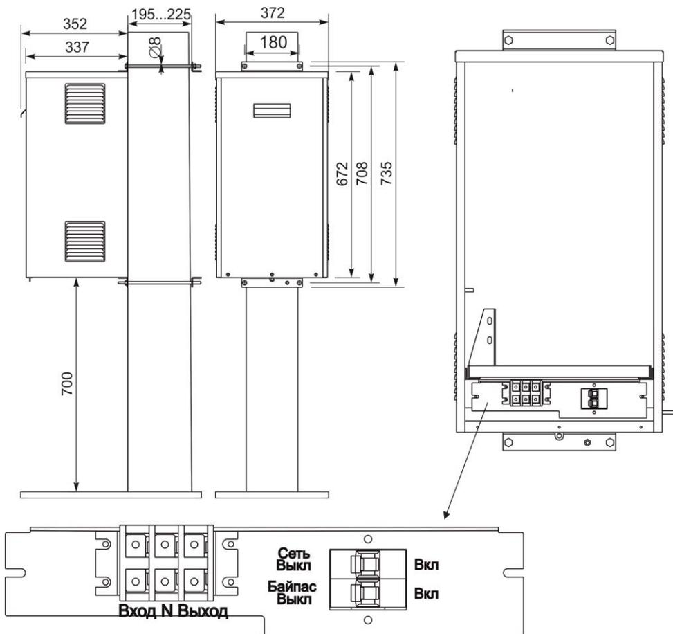
Рисунок 1 – Габаритные и установочные размеры шкафа
